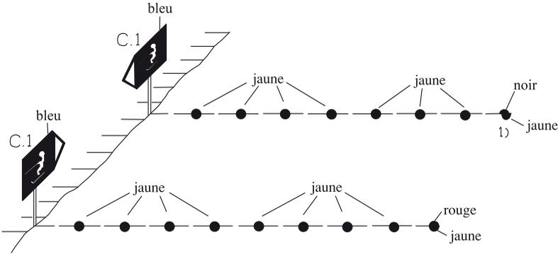
1) Bouées en forme de bicône ou sphère d'un diamètre de 0,40 m au moins et d'un diamètre double pour les deux bouées d'entrée côte large du chenal.
